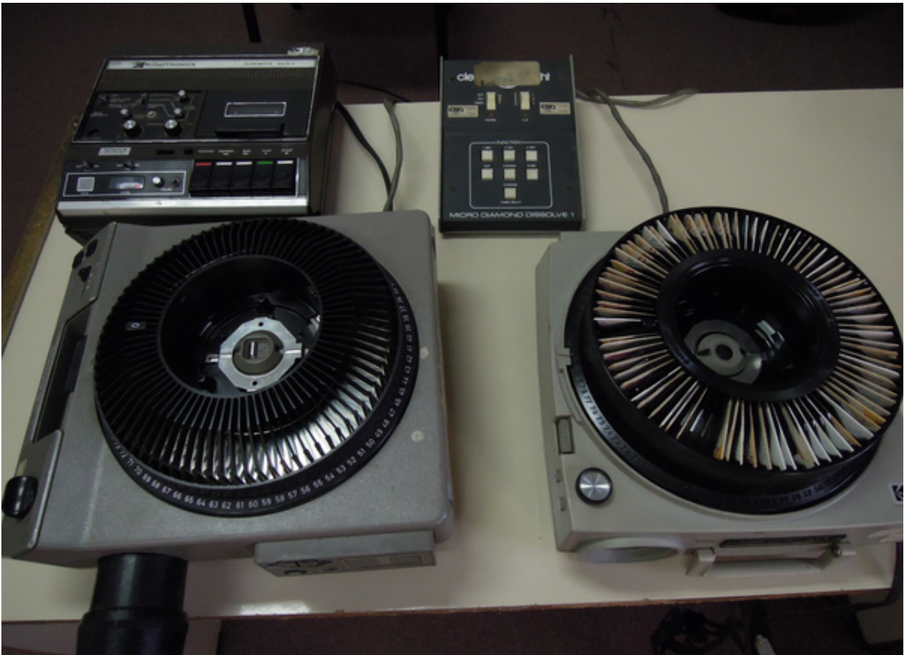
Figura 1: Equipos necesarios para la exhibición de un diaporama compuesto por dos proyectores, un casetero capaz de identificar la señal y combinar el pase de diapositivas y un mezclador.
